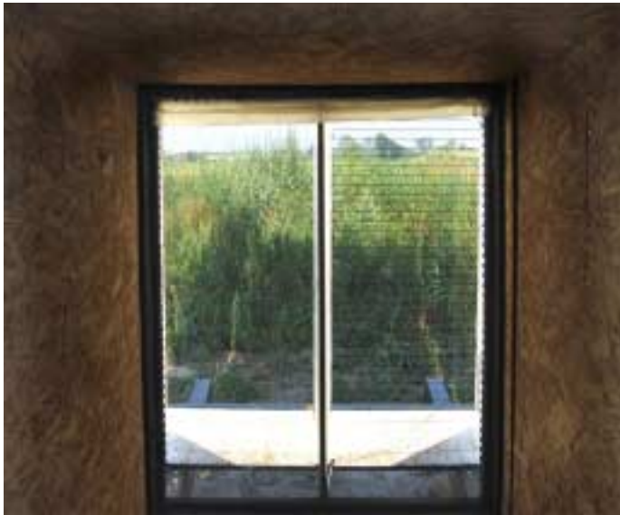
Abbildung 1: Der Wahlversuch zeigt, ob die Vögel die markierte Scheibe (rechts) wahrnehmen und von einer unmarkierten Referenzscheibe (links) unterscheiden. Ein Netz 40cm vor den Scheiben verhindert, dass Vögel auf dem Glas aufprallen. Bei sehr guten Markierungen fliegen 95% der Vögel zur Referenzscheibe, nur 5% treffen „Fehlentscheidungen“ und fangen sich auf der Seite der markierten Scheibe im Netz.
